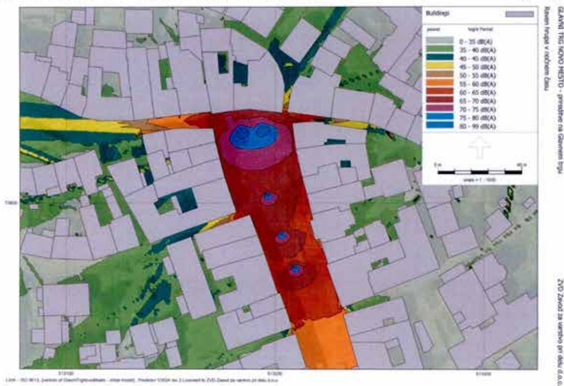
Slika 10.18: Ocenjena raven hrupa v nočnem času. Barve prikazujejo ravni hrupa v stopnjah po 5 dBA, kot je to prikazano na barvni lestvici. Karta prikazuje A vrednotene ekvivalentne ravni hrupa zaradi obratovanja zvočnih naprav.
