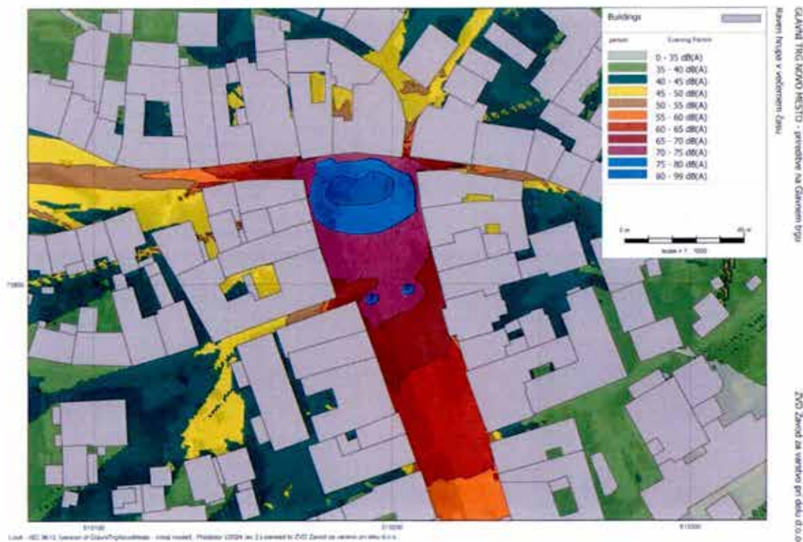
Slika 10.7: Ocenjena raven hrupa v večernem času. Barve prikazujejo ravni hrupa v stopnjah po 5 dBA, kot je to prikazano na barvni lestvici. Karta prikazuje A vrednotene ekvivalentne ravni hrupa zaradi obratovanja zvočnih naprav.
