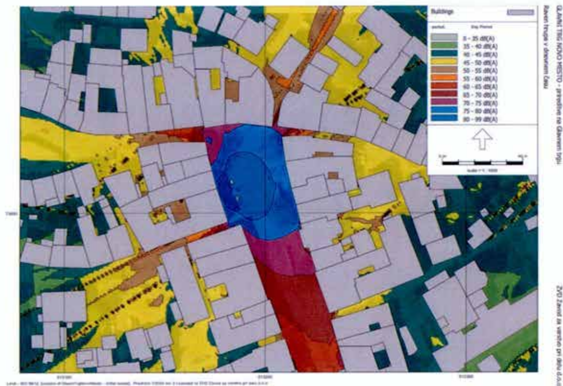
Slika 10.28: Ocenjena raven hrupa v dnevnem času. Barve prikazujejo ravni hrupa v stopnjah po 5 dBA, kot je to prikazano na barvni lestvici. Karta prikazuje A vrednotene ekvivalentne ravni hrupa zaradi obratovanja zvočnih naprav.
