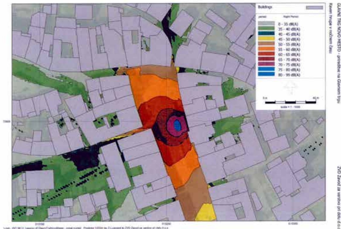
Slika 10.38: Ocenjena raven hrupa v nočnem času. Barve prikazujejo ravni hrupa v stopnjah po 5 dBA, kot je to prikazano na barvni lestvici. Karta prikazuje A vrednotene ekvivalentne ravni hrupa zaradi obratovanja zvočnih naprav.
