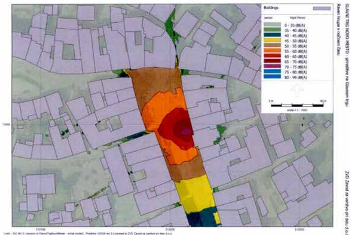
Slika 10.42: Ocenjena raven hrupa v nočnem času. Barve prikazujejo ravni hrupa v stopnjah po 5 dBA, kot je to prikazano na barvni lestvici. Karta prikazuje A vrednotene ekvivalentne ravni hrupa zaradi obratovanja zvočnih naprav.
