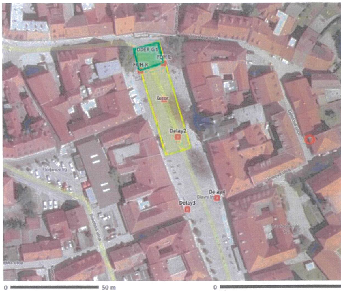
Slika 3: shema postavitve zvočnikov in odra
